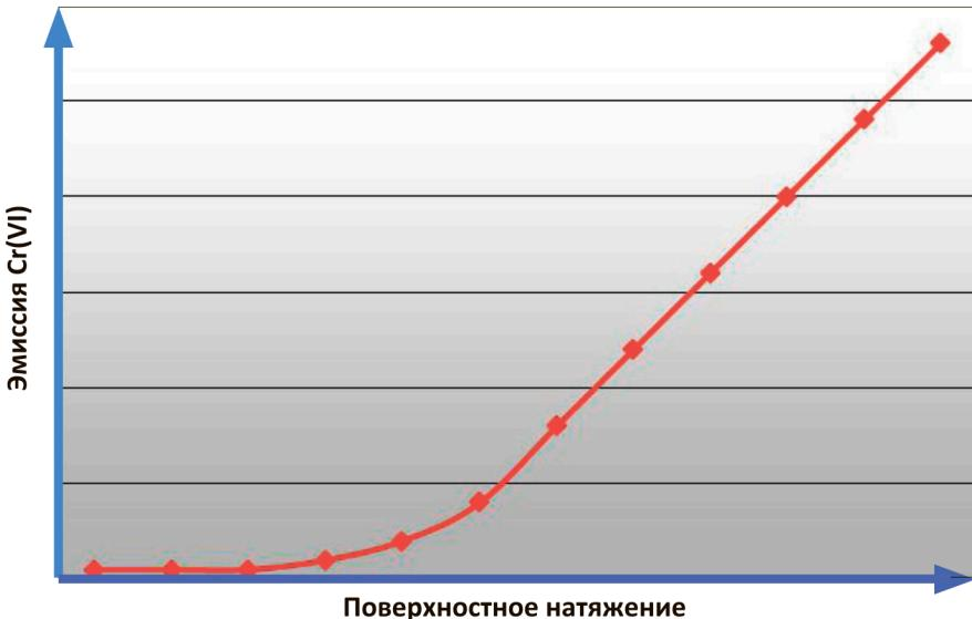
ПАВы уменьшают поверхностное натяжение, за счёт чего уменьшаются диаметры всплывающих пузырьков. При малых диаметрах пузырьков газа образование аэрозоля электролита практически исключается.
